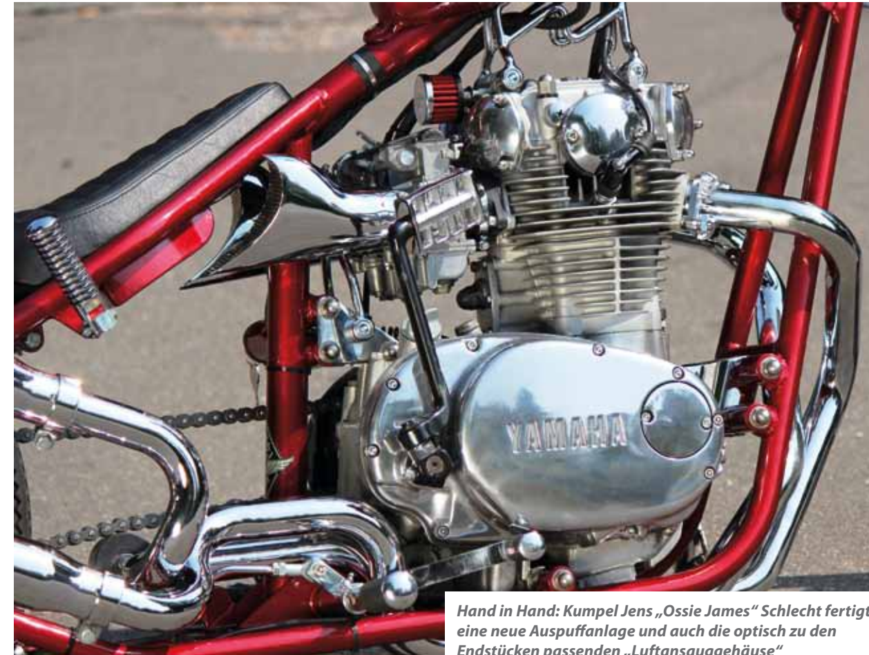
Schnorchel: Beide Ansaugtrichter waren einst Endstücke von Fishtail-Auspufftöpfen. Die Kabel des Lenkschlusses verschwinden direkt im Rahmen
