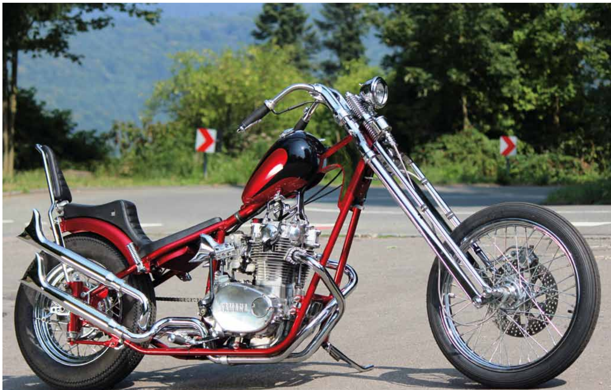
Fiedler Frame: Der Rahmen mit dem hohen Lenkkopf und dem langen, gefederten Heck wurde in Hartmut Fiedlers Firma für Fahrzeugtechnik in Bremerhaven gebaut. Obwohl sich Fiedler heute mehr mit Wohnmobilen beschäftigt, sind Chopper-Fahrwerke immer noch zu bekommen
