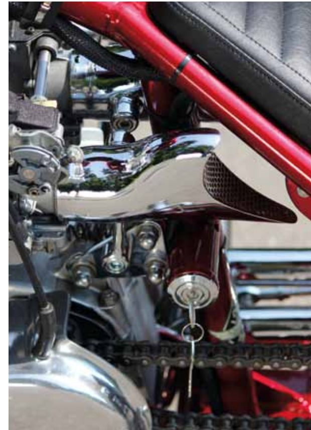
Schnorchel: Beide Ansaugtrichter waren einst Endstücke von Fishtail-Auspufftöpfen. Die Kabel des Lenkschlösses verschwinden direkt im Rahmen
