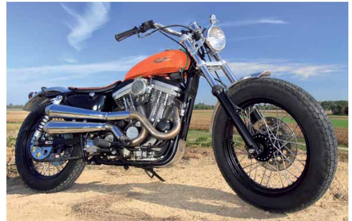
Aus einer ziemlich vergammelten 883er Sportster baute der Franzose Francis Garnier diesen coolen Scrambler auf. Der Motor wurde komplett überholt, der Auspuff hochgelegt und grobstollige 19-Zöller auf Drahtspeichenfelgen gezogen.
