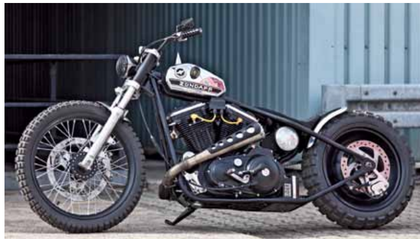
Bikes in eigenwilliger Optik, meist rau und rotzig, sind der Stil des Heidelbergers Martin Becker. Die Gabel für den Starrrahmenumbau spendierte eine Buell, das Hinterrad stammt aus einer V-Rod. Der Zündapp-Tank lässt sich mit wenigen Handgriffen gegen einen größeren tauschen.
