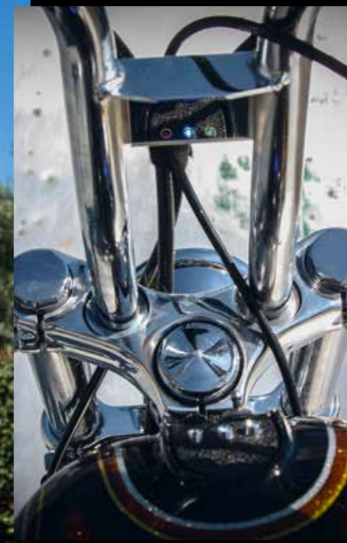
Kontrollleuchten und Schalter rücken durch den Spiegel am Lenker ins Blickfeld
