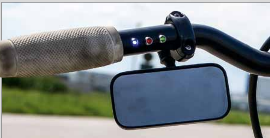
Saubere Sache: Die vom Gesetzgeber geforderten Kontrollleuchten sind links im Lenker platziert
