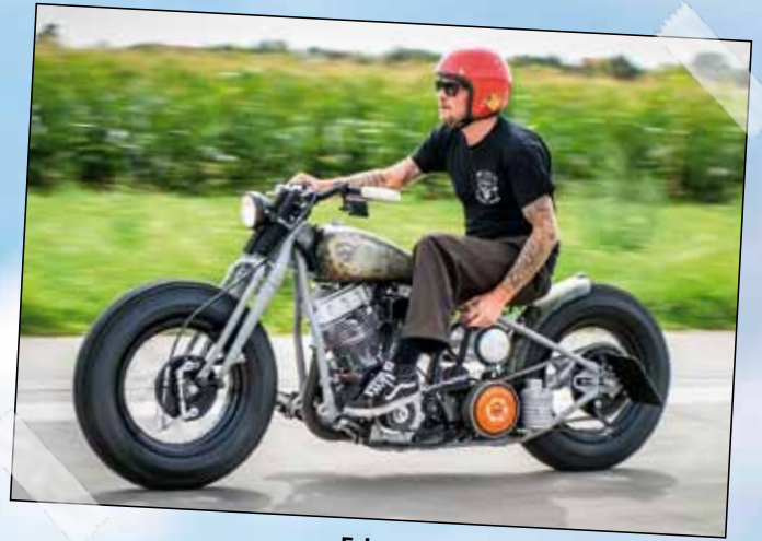
Erbauer Maddin mit der Hand am Skull. Gekuppelt wird mit dem linken Fuß, geschaltet per Jockeyshift
