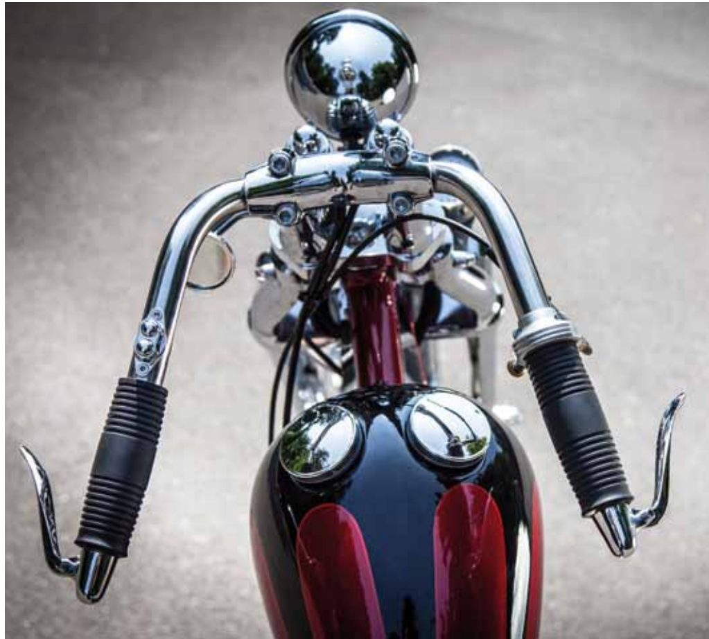
Alles Chopper oder was? Eine lange Gabel, ein cleanes Fahrwerk, der zweiteilig verstellbare Lenker ein Rabbit Ear, Scallops auf dem Tank. War noch was? Klar, King- and-Queen-Sitzbank für den perfekten Ritt
