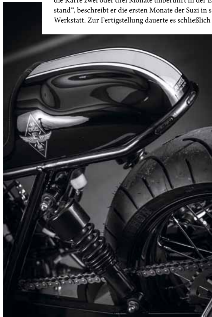
Der lackierte Carbon-Bürzel bietet der Elektrik und dem LiFePo-Akku ein schützendes Dach – unver-schämt schön ist er dazu
